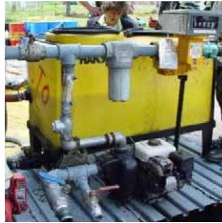
B) Mezclador para el glifosato y el adyuvante
