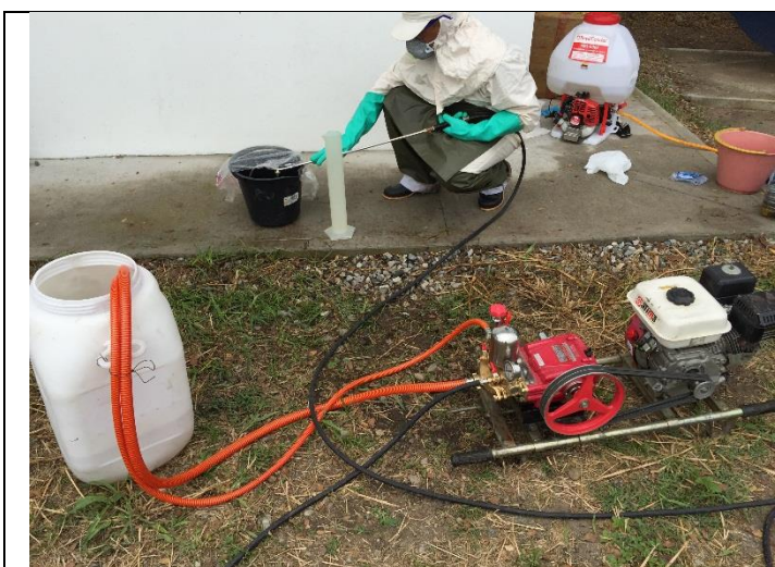
Técnica para prueba de descarga equipo estacionario.
