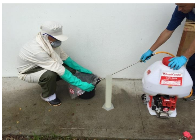
Técnica para prueba de descarga equipo de espalda.
